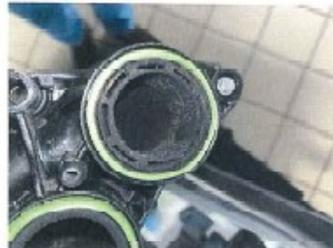
L'effetto del cloro, che ricordiamo come da normativa UNI EN 590 deve essere pari a 0 mg/l nel gasolio, ha causato inoltre la perdita di tenuta del cilindro n. 3 compromettendo il corretto funzionamento del motore. Questa prova è stata effettuata con attrezzatura ufficiale di Audi e documentata»;
